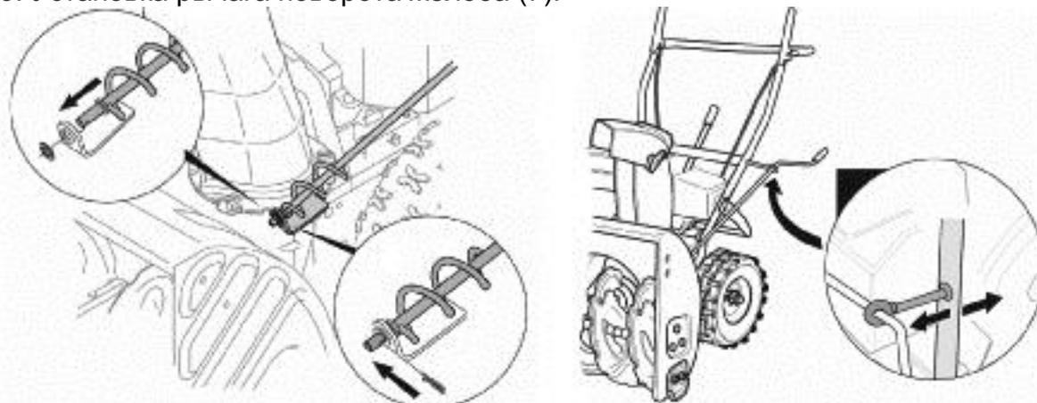
Рычаг для поворота желоба (7) крепится на корпусе при помощи шплинта, на рукоятке управления при помощи кронштейна (8).
