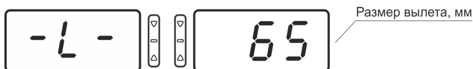
Рисунок 6.3 – Показания индикаторов во время пользования электронной линейкой для измерения дистанции (измеритель диаметра выключен)
