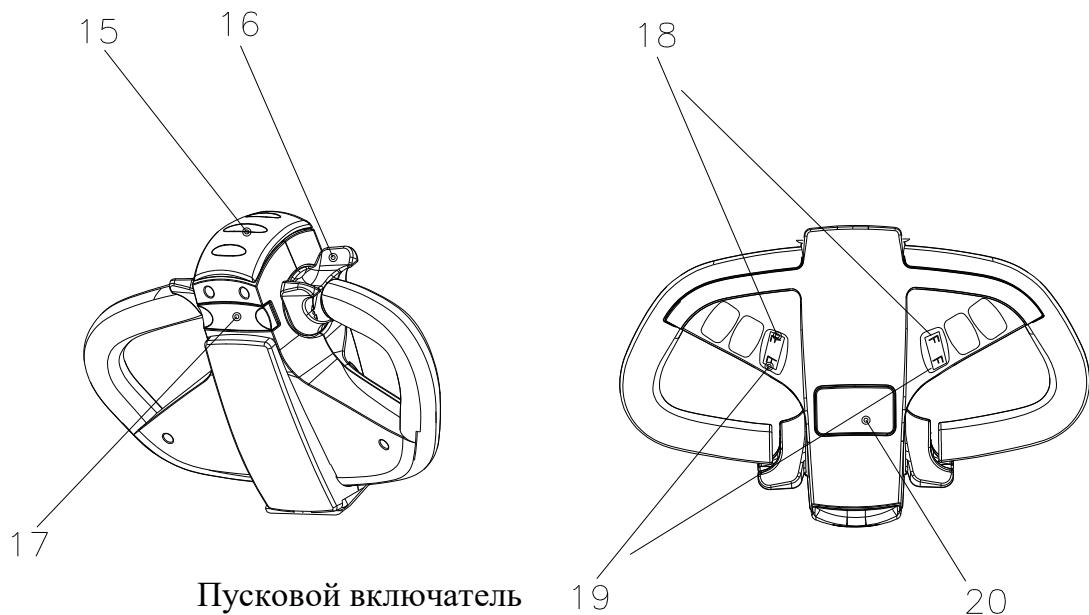
При помощи данного включателя регулируют включение и отключение оборудования от источника тока.
